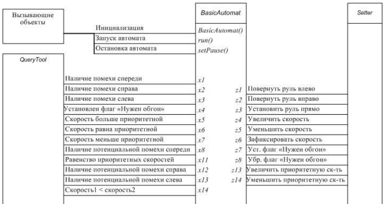
Рис. 16. Структурная схема класса BasicAutomat
