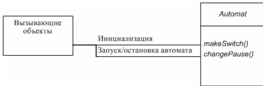
Рис. 15. Структурная схема класса Automat
