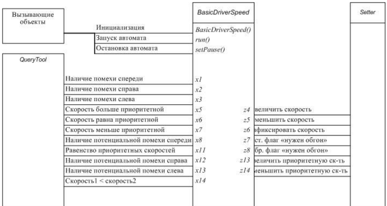
Рис. 17. Структурная схема класса BasicDriverSpeed
