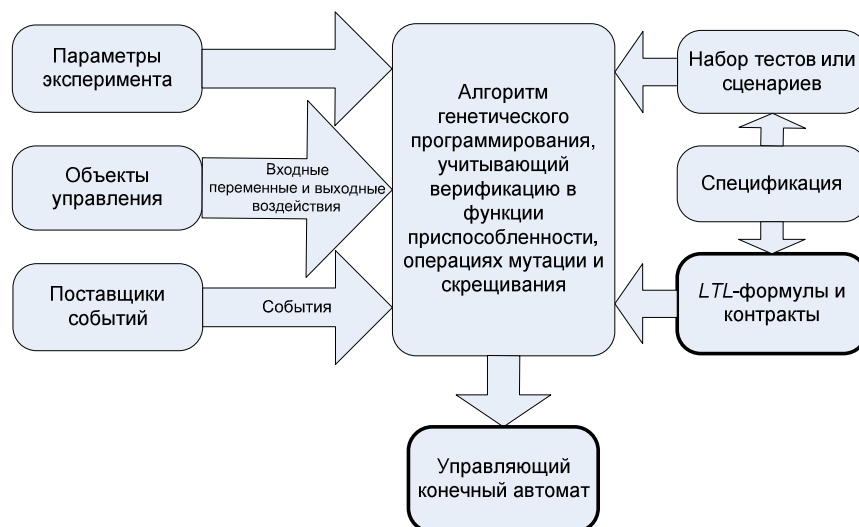
Рисунок 7 – Схема, соответствующая технологии генерации автоматов на основе генетического программирования и верификации
