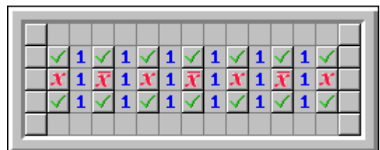
Рис. 21. Проводник (элемент 1) и инвертор (элемент 6)
