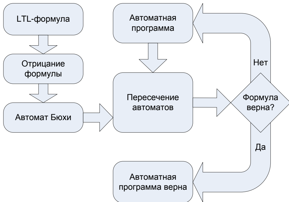
Рис. 3. Схема работы верификатора
