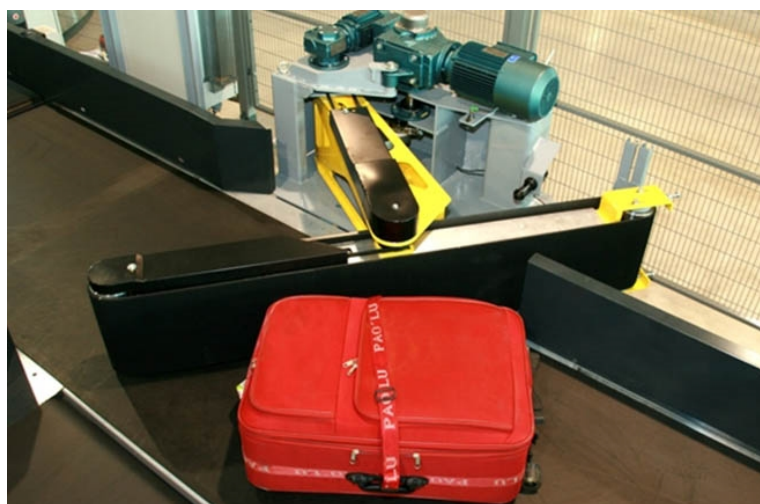
Рисунок 1 – Отклонитель отклоняет сумку на смежный конвейер
