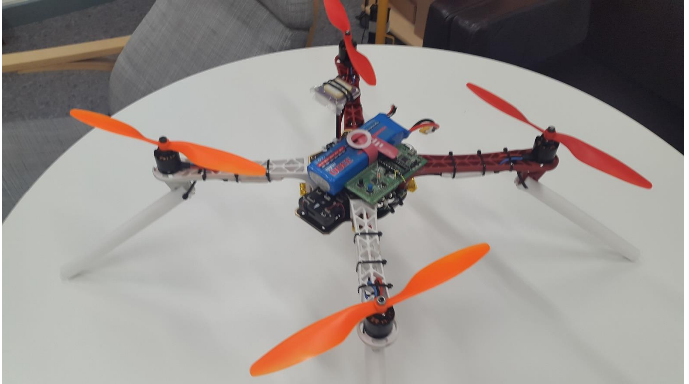
Рисунок 19 – Общий вид собранного квадрокоптера.
