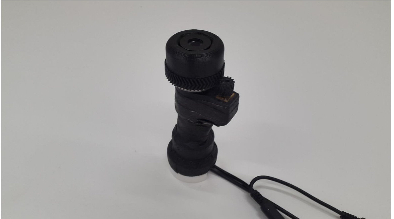
Рисунок 21 – Готовая конструкция генератора вращающейся лазерной плоскости.
