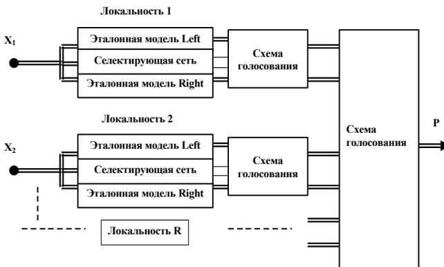
Рис. 7. Модель иерархического классификатора с согласованной структурой реализации частных классификаторов использовались двухслойные нейронные сети прямого распространения с сигмоидными функциями активации в первом слое и линейными функциями во втором. Входной вектор
