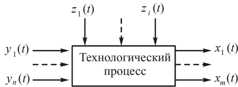
Рис. 4.3. Структурная схема многомерного технологического процесса с выделением параметров z , характеризующих ход процесса
