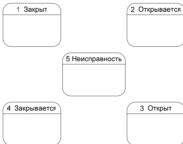
Рис. 2.5. Состояния системы управления клапаном
